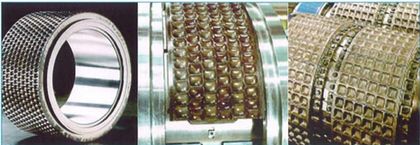
Abb. 4 Verschiedene Werkzeugausführungen (von links): Bandage, Segmente, Streifensegmente
