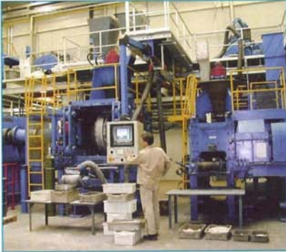
Abb. 5 Köppern Technikum. Links Walzenpresse 52/10, rechts 52/6,5
